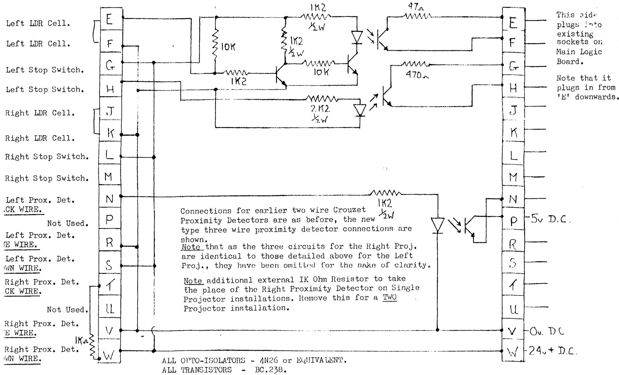
OPERATION CONTROLS. OPTO-ISOLATION PLUG IN PRINTED CIRCUIT BOARD.
