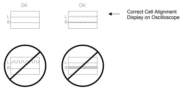
CELL ALIGNMENT ON OSCILLOSCOPE
