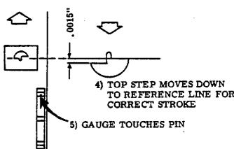
Figure 3-80. CLAW PULL DOWN STROKE
