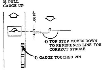
Figure 3-74. CLAW PULL DOWN STROKE
