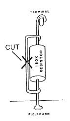
CUTTING THE WIRE JUMPER WILL IN-SERT AN AUDIO PAD INTO EACH INPUT A 220-240 50/60 HZ VERSION OF THE EX500B IS AVAILABLE ON SPECIAL ORDER. THE PRICE IS SLIGHTLY HIGHER. PLEASE ALLOW 2 WEEKS DELIVERY FOR THIS SPECIAL PRODUCT.
